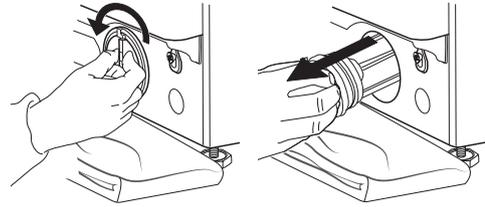
10. Vyčistite filter: odstráňte zvyšky z filtra a očistite ho pod tečúcou vodou.
