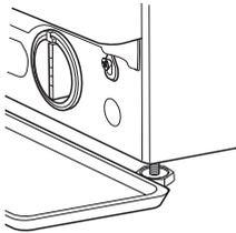
8. Vypustite vodu: Pomaly otáčajte filter proti smeru hodinových ručičiek, kým nevytečie všetka voda. Nechajte vodu vytekať, ale filter neodstraňujte. Keď sa nádoba naplní, zatvorte filter otáčaním v smere hodinových ručičiek. Vyprázdnite nádobu. Opakujte tento postup, až kým nevytečie všetka voda.
