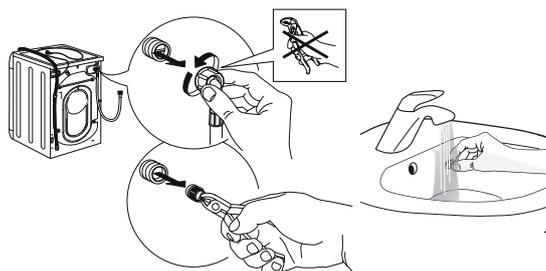
4. Vložte sitkový filter na pôvodné miesto. Pripojte hadicu späť k vodovodnému ventilu a práčke. Na pripojenie hadice nepoužívajte náradie. Otvorte ventil prívodu vody a ubezpečte sa, či sú spojenia pevné.
