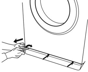
7. Nádoba na vypustenú vodu: Umiestnite pod vodný filter nízku a širokú nádobu na zachytenie zvyšnej vody.
