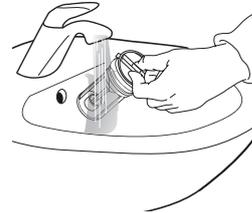
11. Vložte vodný filter a nasadte späť sokel: Vložte filter späť na svoje miesto krútením v smere hodinových ručičiek. Zapojte ho čo najrýchlejšie; držadlo filtra musí byť v zvislej polohe. Vodotesnosť filtra vyskúšate tak, že do dávkovača pracieho prostriedku nalejete asi 1 liter vody. Potom nasadte späť sokel.
