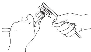
3. Teraz ručne odskrutkujte prívodnú hadicu zo zadnej strany práčky. Vytiahnite sitkový filter z prípojky práčky kombinačkami a opatrne ho vyčistite.
