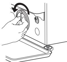
9. Odstráňte filter: Pod filter položte bavlnenú handru, ktorá absorbuje malé množstvo zostávajúcej vody. Odstráňte filter otáčaním proti smeru hodinových ručičiek.
