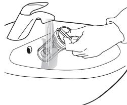
11. Vložte vodný filter a nasadte späť sokel: Vložte filter späť na svoje miesto krútením v smere hodinových ručičiek. Zapojte ho čo najrýchlejšie; držadlo filtra musí byť v zvislej polohe. Vodotesnosť filtra vyskúšate tak, že do dávkovača pracieho prostriedku nalejete asi 1 liter vody. Potom nasadte späť sokel.
