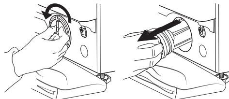
10. Vycistite filter: odstráňte zvyšky z filtra a očistite ho pod tečúcou vodou.
