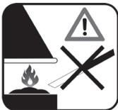
Nevysávejte žhavé uhlíky, hořící předměty, předměty přesahující teplotu 40°C (104°F).
