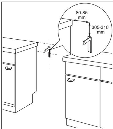
2. Tento otvor naleznete na levé straně zadní části spotřebiče. Nadzdvihněte přední stranu spotřebiče a umístěte ji doprostřed prostoru mezi kuchyňskými skříňkami. Jestliže je prostor mezi pracovními plochami kuchyňské linky větší než šířka spotřebiče, pak je třeba upravit boční rozměry směrem ke středu spotřebiče.
