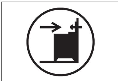
1. Ochrannu proti prevráteniu nainštalujte 305 - 310 mm pod vrchným povrchom spotrebiča a 80 - 85 mm od bočnej strany spotrebiča do okrúhleho otvoru na konzole. Naskrutkujte ju do pevného materiálu alebo použite vhodnú podporu (stenu).
