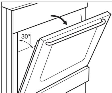
2. Uchopte okrajovou lištu na horní straně dvířek (B) na obou stranách a zatlačením směrem dovnitř uvolněte svorku těsnění.
