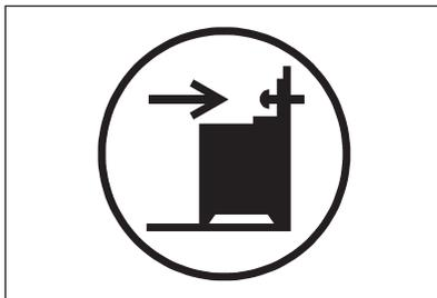
1. Nainstalujte ochranu proti překlopení 305 - 310 mm pod úroveň horní plochy spotřebiče a 80–85 mm od boční strany spotřebiče skrze kruhový otvor na konzoli. Přišroubujte jej do pevného materiálu nebo použijte vhodnou oporu (zeď).
