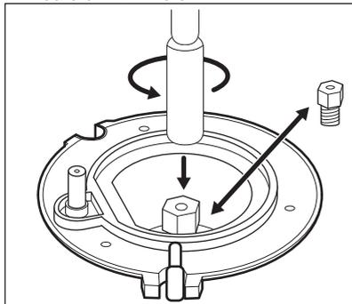
5. Vymeňte typový štítok (bližšie k prívodnej plynovej rúre) za štítok pre nový typ prívodu plynu.
